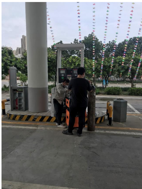
油气回收装置监测采样照片 1
